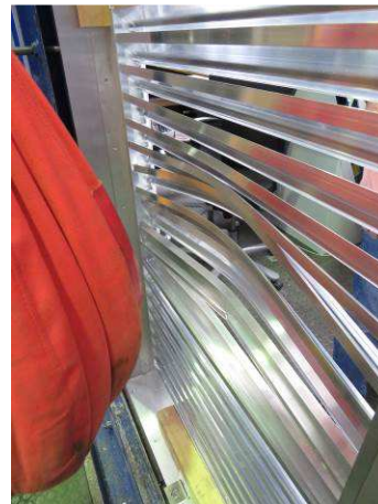
Prüfkörper nach der Prüfung Außenseite Fallhöhe 750 mm.
