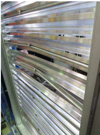
Prüfkörper nach der Prüfung Raumseite Fallhöhe 750 mm
