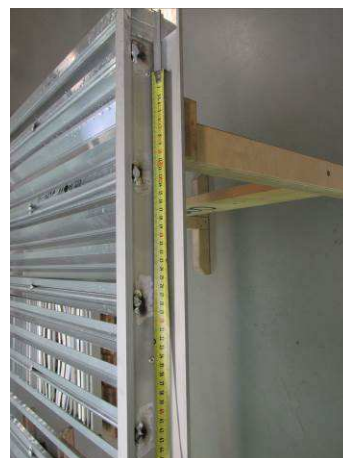
Aluminiumrundstäbe beidseitig mit Rahmen verschweißt im Abstand von 150 mm eingesetzt
